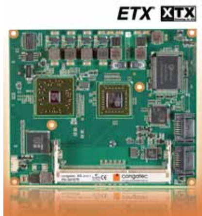
Tutti i nuovi moduli della famiglia Fusion (conga-BAF, conga-EAF e conga-XAF) utilizzano cinque versioni di processore serie G di AMD, con frequenze da 1,0 a 1,6 GHz e varianti single o dual core
