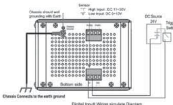
**Nota: La DI acepta señal DC con un circuito de entrada aislado cuyo nivel alto está en DC 11V~30V y cuyo nivel bajo está en DC 0V~10V.**
