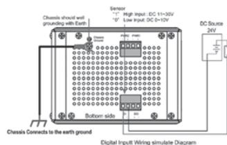
**Beachte: Der digitale Eingang verarbeitet DC Spannungssignale und verfügt über eine Isolation. Der Eingangszustand ist EIN bei DC 11V~30V und AUS bei DC 0V~10V.**
