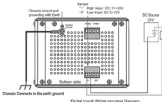
**Примечание:** Цифровой вход поддерживает сигналы постоянного тока и поддерживает схему работы с верхним значением DC 11V~30V и нижним значением DC 0V~10V.
