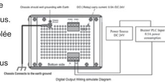
**Note: Le contact du relais supporte seulement 0.5A sous 24VDC. Il n'est pas recommandé d'appliquer un courant ou une tension dépassant ces spécifications.**
