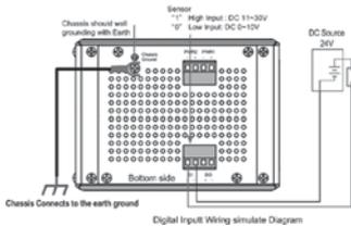
**Note: L'entrée DI accepte un signal DC et dispose d'un circuit d'entrée isolé avec un niveau logique Haut de 11V~30VDC et un niveau logique Bas de 0V~10VDC.**
