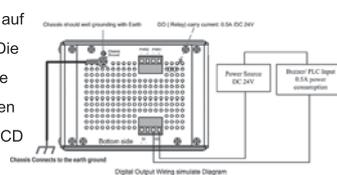
**Beachte: Die Relaiskontakte unterstützen 0.5 A bei DC 24V. Es wird empfohlen keine höhere als die spezifizierte Belastung anzulegen**
